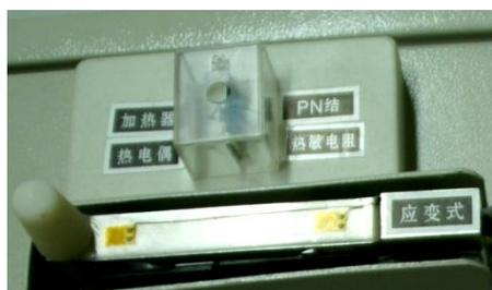
圖 5 A. 感測元件平台上之壓克力小方盒內附有加熱器、熱電偶、PN 結和熱敏電阻等四個元件。
