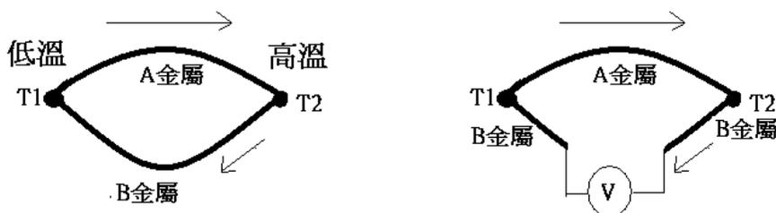
圖 3 熱電偶溫度計的示意圖，由兩條不同材質的金屬線，兩端點以硬焊方式，點焊成兩個溫度接點，使之形成電路回路。當兩溫度接點所接觸的溫度不同的話，則會在回路上產生一微小的電位差，此電位差即稱之為熱電位。
