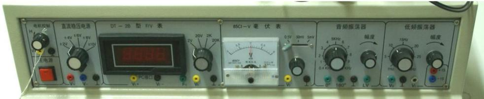
(b) 電源控制單位和經轉換為電壓信號後之 F/V 電壓讀取表。
