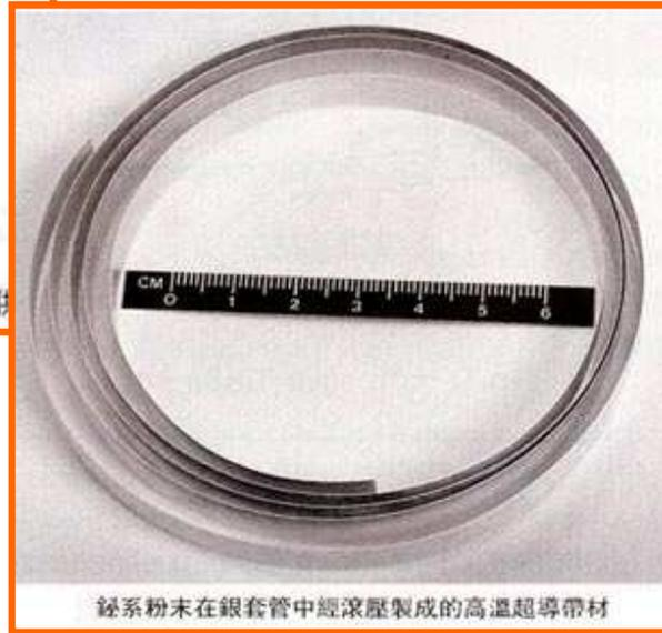
鈹系粉末在銀套管中經滾壓製成的高溫超導帶材
