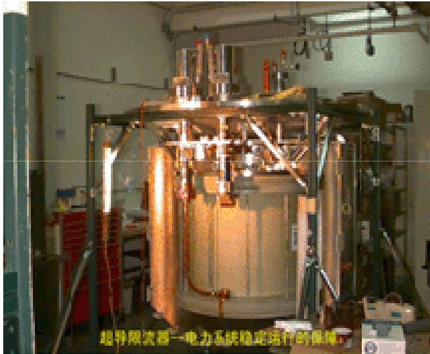
超導故障限流器 (SFCL) 是利用超導體的超導/正常態轉變特性，快速而有效地限制電力系統故障短路電流的一種電力設備。SFCL的工作原理是短路電流超過超導體的臨界電流，引起超導體失超，超導體從超導態轉變為正常態，限流器呈現很大阻抗，短路電流得以限制。SFCL具有如下的優點：
