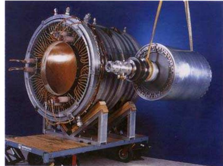
銱-鈦超導轉子使僅有一米長、一米直徑的發電機可以達到兩萬瓩(20 Megawatt)的功率(美國General Electric製作, 圖片由U.S. Air Force Wright Laboratory提供)
