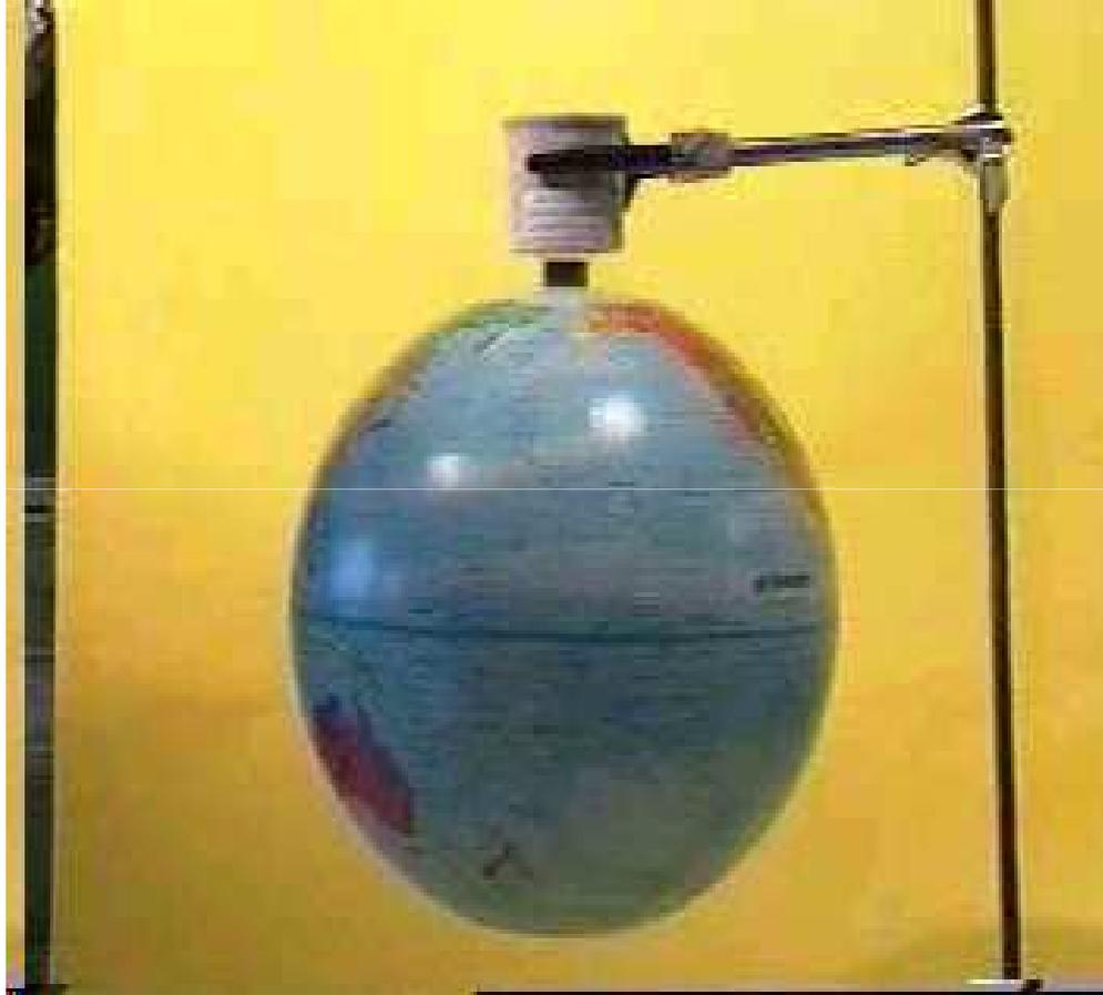
將超導體置入架上之容器中並倒入液態氮使之產生超導態，強磁鐵和單晶粒Y - Ba - Cu - O超導塊材之間利用場冷過程可使磁鐵磁旋浮起並保持固定的距離，以及無接觸、無磨擦的磁懸浮特性。因此地球儀可以完全無接觸地懸掛在空氣中，並可以接近無磨擦、無接觸在空中旋轉(僅有與空氣之摩擦力)。
