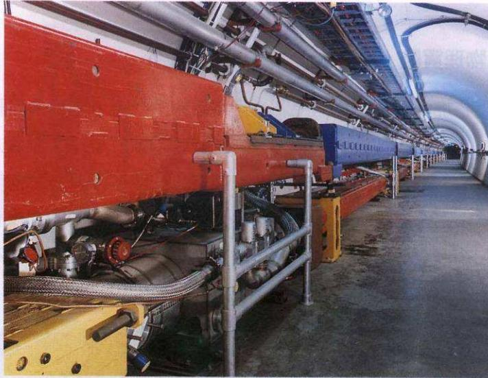
(a) 在Tevatron中正常導體磁體下方加裝了一組超導體磁體
