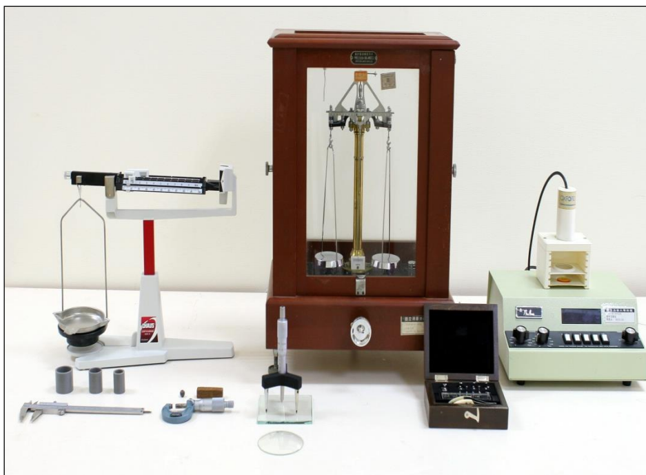
圖 1: 基本度量實驗使用的器材和各種待測物。後排左至右分別為槓桿式天平、等臂式天平、輻射偵測器暨輻射偵測頭；前排左至右：游標尺、螺旋測微器、球徑計(曲度量測器)和砝碼組。以及三個不同內徑的塑膠圓柱管、鐵球、長方體木塊、平面玻璃片和曲面玻璃。另有準確度 0.02 g 的電子天平和準確度高達 10-5 g 的高精密分析電子天平(未呈列於照片中)。
