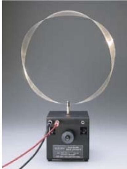
圖11 金屬環圓共振實驗架設圖，圖中並顯示具有五個節點的典型駐波結果。
