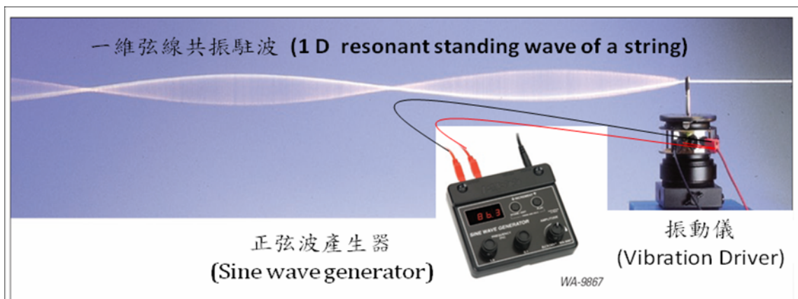
(b) 一維線性弦振動的儀器配置圖和其中一種典型的駐波現象
